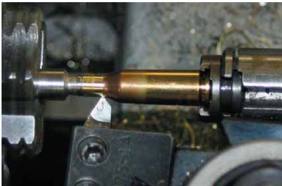
← Тесните патронници на най-прецизните бенчрест карабини изискват външния диаметър на гърлото на използваните гилзи да бъде намален до необходимия размер.
