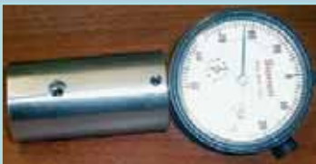
↑ Прецизното измерване на коничното стеснение на патронника е предпоставка за абсолютната точност. Същият инструмент помага за установяване размера на т.нар. „главна дължина“.
